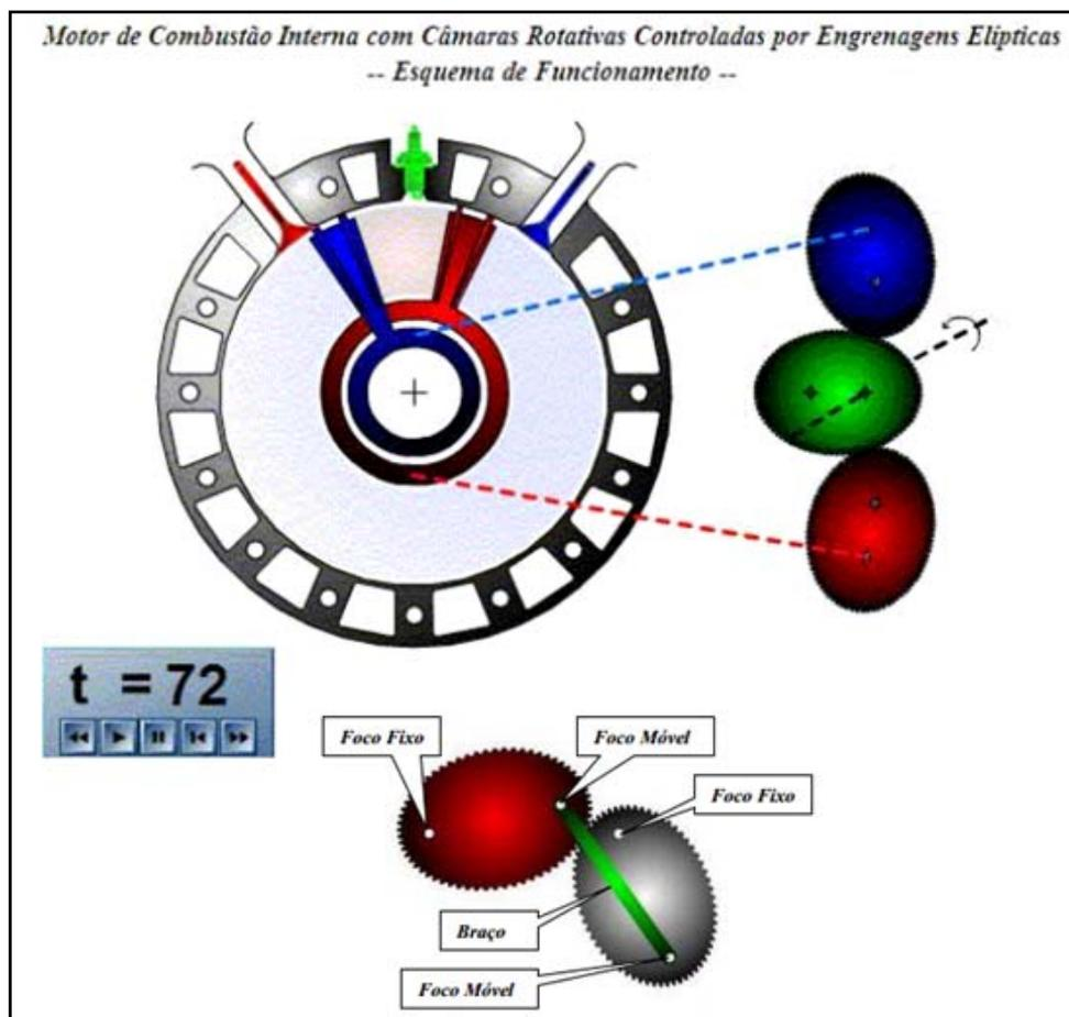
Figura 4 - Engrenagens elípticas em um motor de combustão
