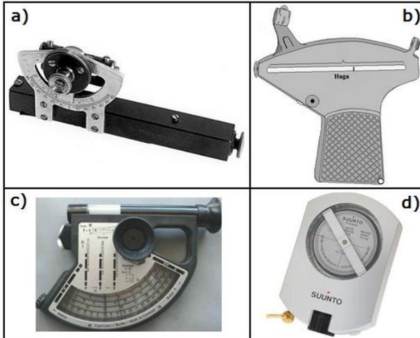
Alguns hipsômetros apresentam escalas graduadas em porcentagem. A escala percentual é baseada numa unidade angular representada pela razão de 1 unidade na vertical para 100 unidades na horizontal. Por exemplo, uma arco percentual de 25% significa um desnível de 25 metros entre dois pontos distanciados entre si em 100 metros.
