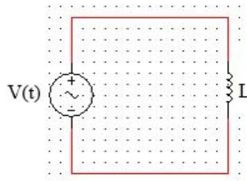
Figura 45 – Circuito elétrico composto por fonte e indutor
