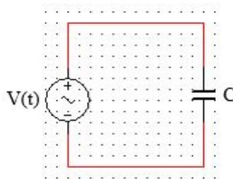
Figura 44 – Circuito elétrico composto por fonte e capacitor
