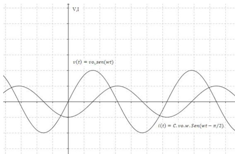
Figura 46 – Gráficos de tensão e corrente no mesmo plano - circuito capacitivo
