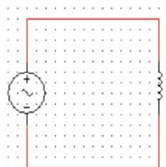
Figura 50 –  $Z_3 = 20\angle 90^\circ\Omega$
