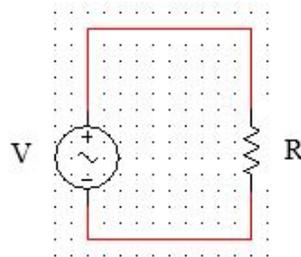
Figura 42 – Circuito elétrico composto por fonte e resistor
