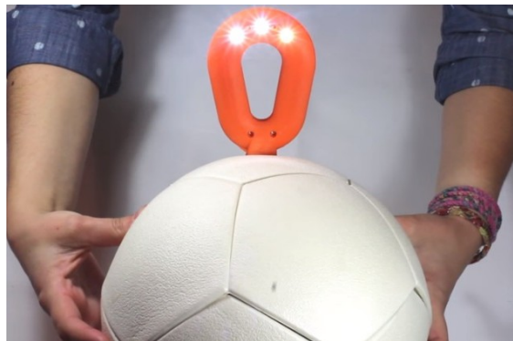
Figura 1.1 – Bola de futebol que armazena energia elétrica através de energia cinética
