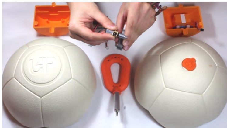
Figura 1.2 – Componentes magnéticos internos da bola que armazena energia
