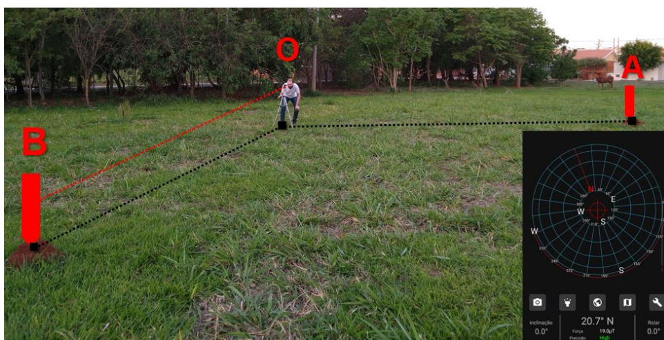
Figura 4.9: Apontamento do teodolito para o Ponto B.
