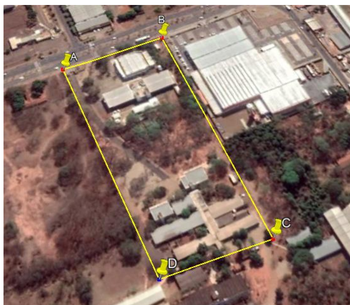
Figura 4.20: Levantamento por coordenadas.
