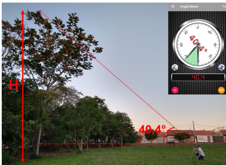
Figura 4.13: Determinando o ângulo da medição.
