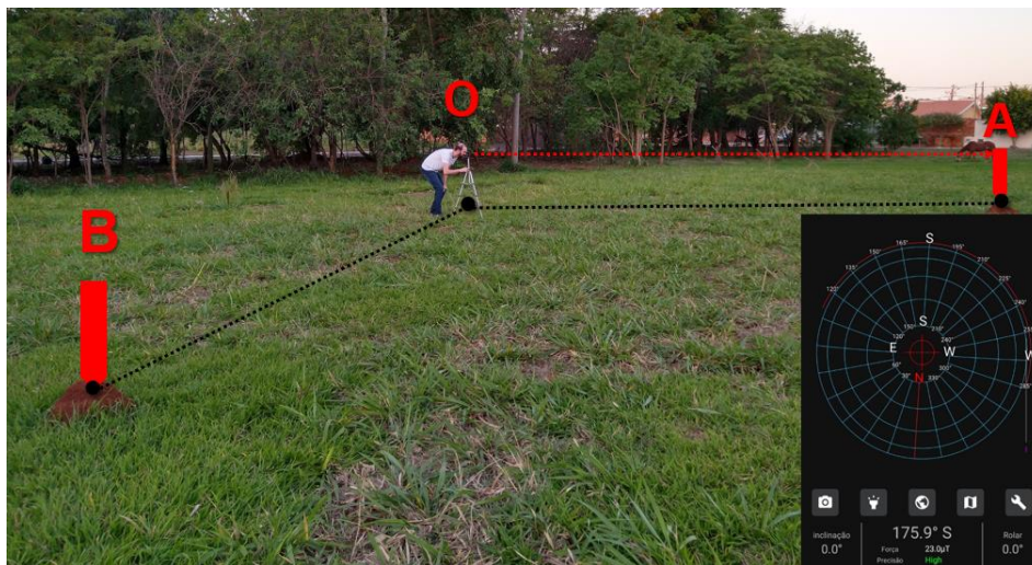
Figura 4.8: Apontamento do teodolito para o Ponto A.
