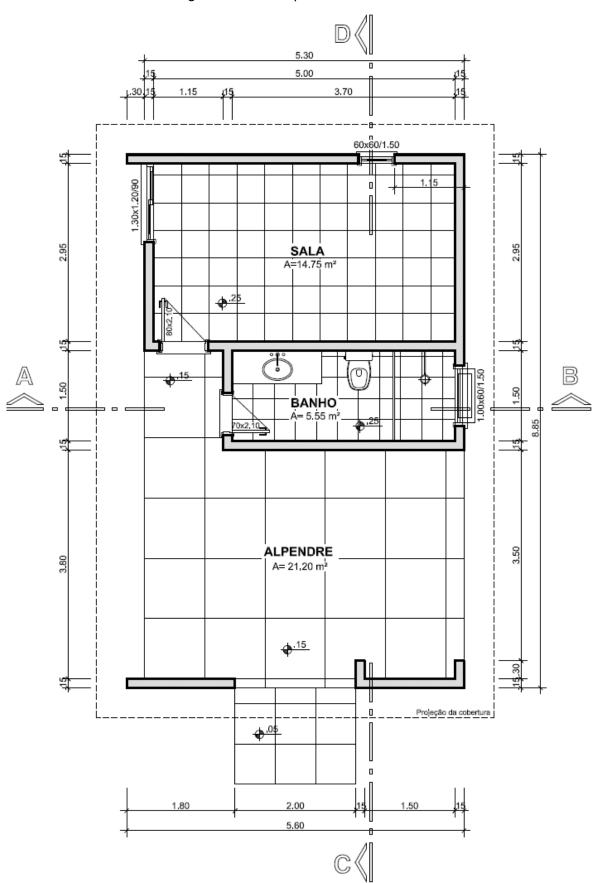
Figura 10 – Exemplo de Planta Baixa
