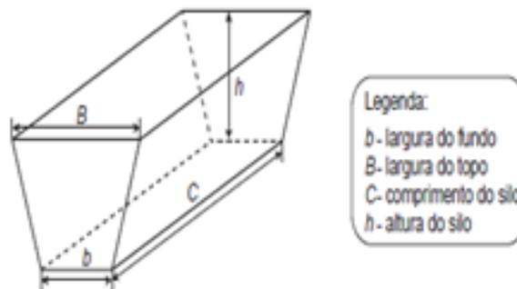
Considere um silo de 2 m de altura, 6 m de largura de topo e 20 m de comprimento. Para cada metro de altura do silo, a largura do topo tem 0,5 m a mais do que a largura do fundo. Após a silagem, 1 tonelada de forragem ocupa  $2 \text{ m}^3$  desse tipo de silo.
