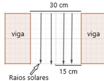
Para atender à proposta do projeto elaborado pelo arquiteto e gerar metade da luz quando o sol inclinar  $30^\circ$  em relação a posição a pino, a viga deverá ter a altura  $x$ , conforme imagem, cujo valor é calculado através da razão trigonométrica, tangente, assim:
