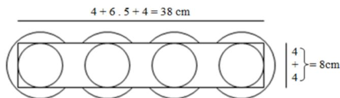
Pois o círculo da base inferior tem raio 4 cm e o círculo da borda superior tem raio 5 cm, somando os raios, a largura mínima será o diâmetro do círculo da base, já para o comprimento, temos seis raios dos círculos das bordas superiores mais dois raios dos círculos das bases.
