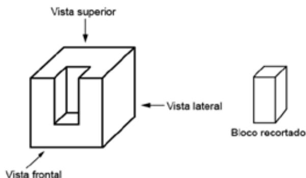
Para isso, o torneiro forneceu, juntamente com o desenho tridimensional da peça, suas vistas frontal, lateral e superior, a partir das posições indicadas na figura. Para facilitar o trabalho do torneiro, as arestas dos cortes que ficam ocultos nas três vistas devem ser representadas por segmentos tracejados, quando for o caso.
