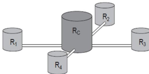
No momento em que o reservatório central está cheio e os auxiliares estão vazios, abrem-se os quatro registros e, após algum tempo, as alturas das colunas de água nos reservatórios se igualam, assim que cessa o fluxo de água entre eles, pelo princípio dos vasos comunicantes.
