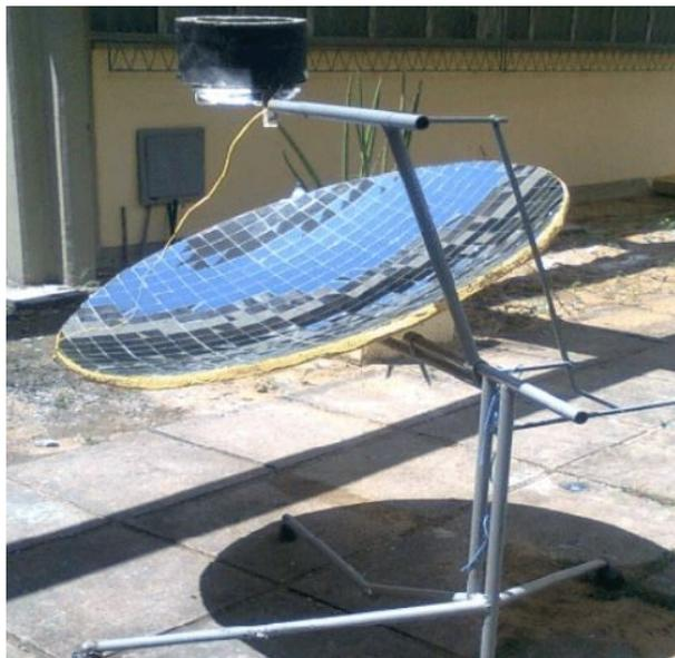
**Figura 4.11:** Fogão solar parabólico
