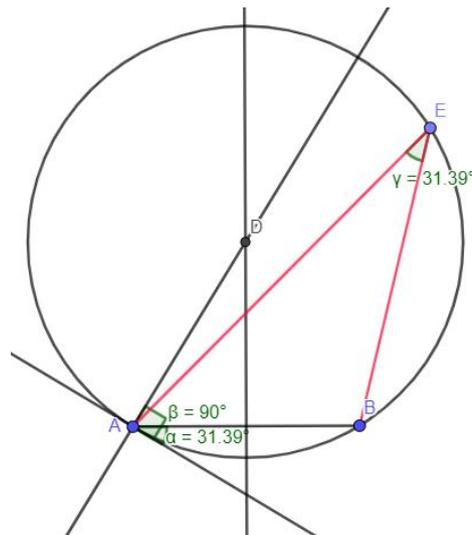
**Figura 2.11:** Quinto passo para construção do arco capaz.
