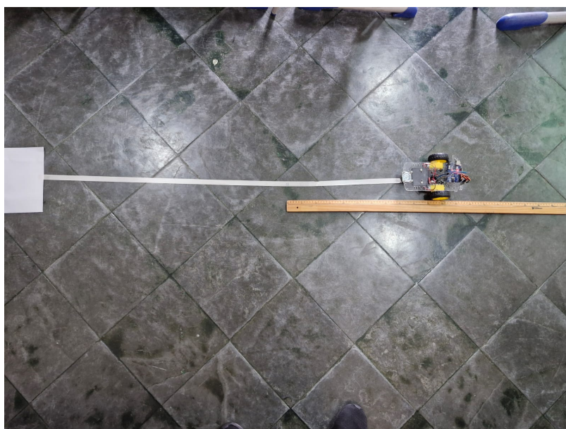
Figura 23 – Determinando a velocidade média
