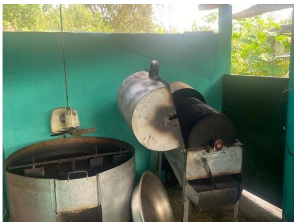
Figura 13: Sistema de torrefação.
