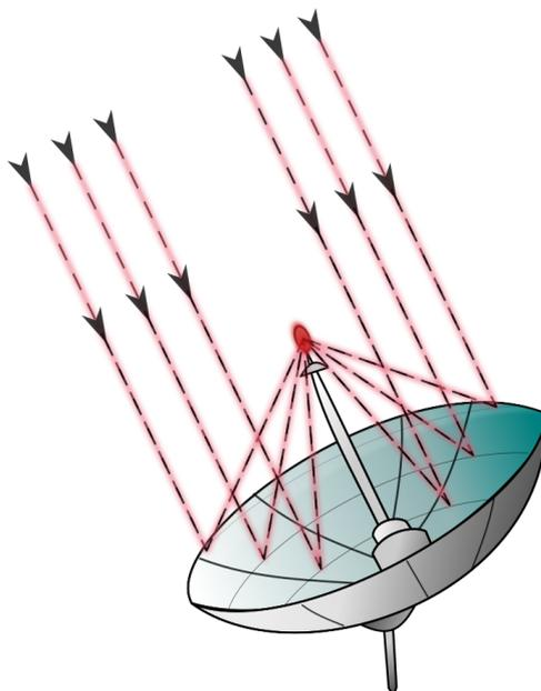
Figura 6.6: Representação da reflexão das ondas de rádio (em vermelho) para o receptor (foco, também em vermelho, no centro)
