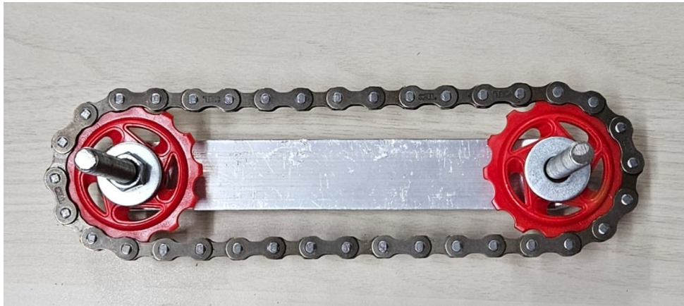
Figura 3.5: Montagem das roldanas e corrente
