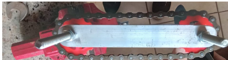
Figura 2.13: Funcionamento do pedivela - posição inicial
