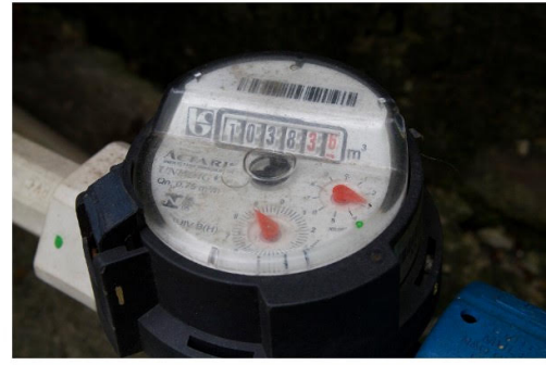
Detalhe de hidrômetro. Aparelho que mede o consumo de água em residências. Foto: Marcos Santos / USP Imagens
