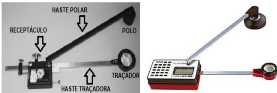
Figura 1: Planímetro de Amsler. a) Planímetro Mecânico. b) Planímetro Digital.
