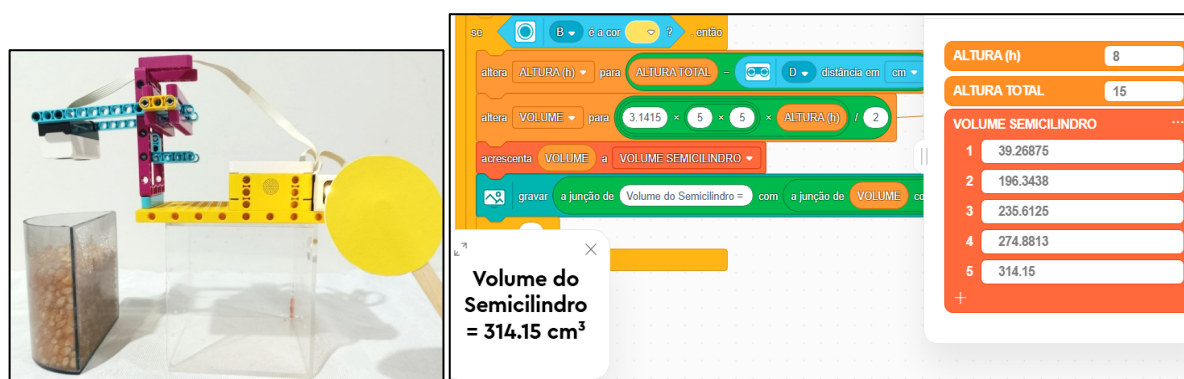
Figura 16 –Volumax equipado para calcular volume de semicilindros e sua tela de visualização
