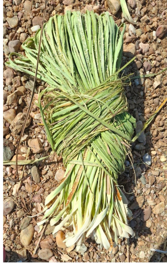
Figura 7- Fibra separada da casca
