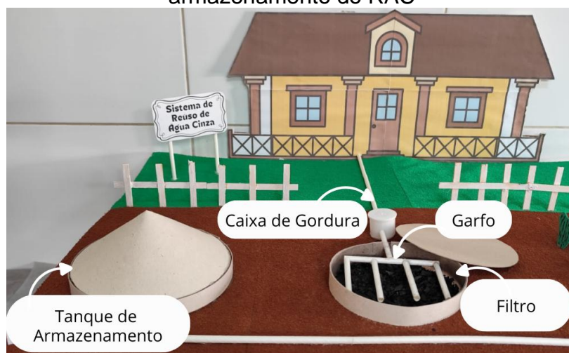
Figura 16 – Vista superior da caixa de gordura, do filtro e do tanque de armazenamento do RAC
