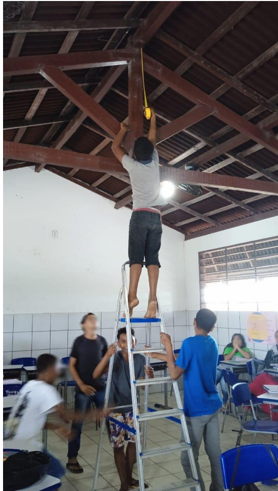
Figura 8 - Medição da estrutura triangular do telhado
