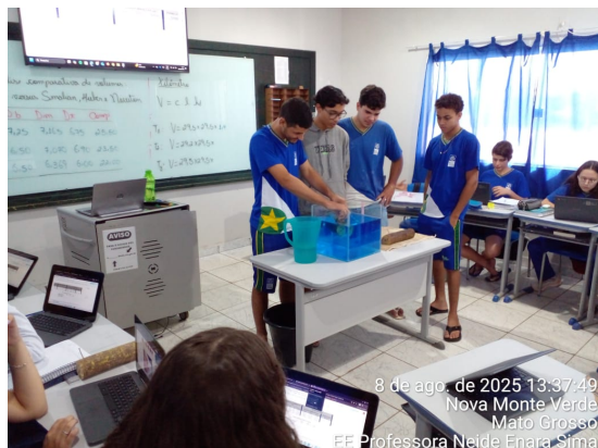
Figura 61 – Alunos submergindo a tora no reservatório e registrando a variação do nível da água para cálculo do volume deslocado.
