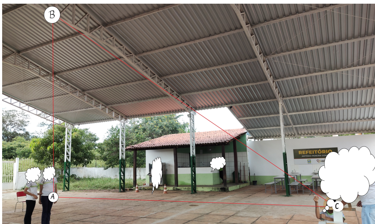
Figura 4.6: Utilizando o teodolito rudimentar para encontrar alturas
