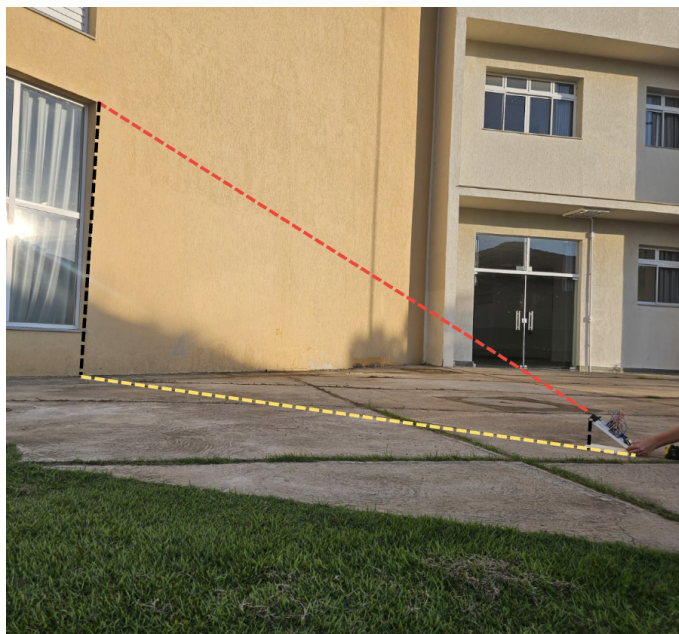
Figura 7.16: Representação esquemática da semelhança entre o triângulo do protótipo (triângulo pequeno) e o triângulo formado com o objeto real (triângulo grande), pelo caso Ângulo-Ângulo (AA). Fonte: Elaborada pela autora (2025).
