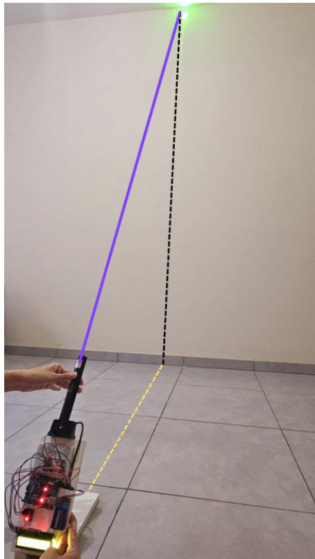
Figura 7.14: Sistema automatizado em funcionamento durante a realização das medições de altura e base. Fonte: Elaborada pela autora (2025).
