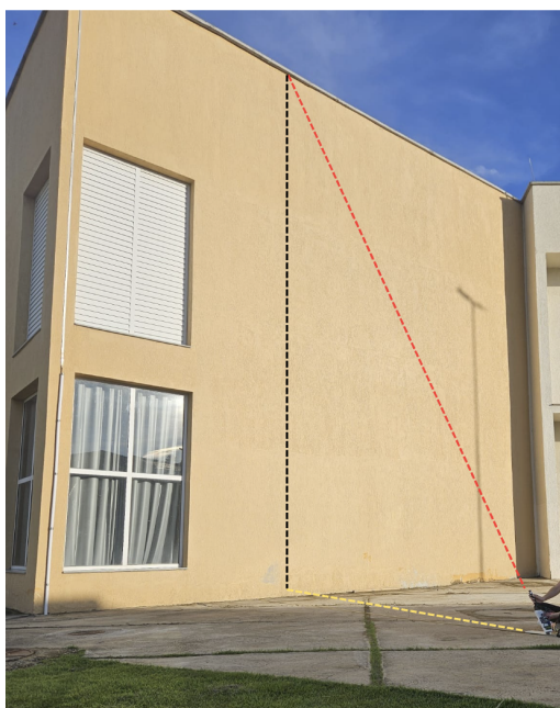
Figura 7.6: Leitura da distância inclinada até o topo da estrutura, correspondente à hipotenusa do triângulo retângulo, realizada com o sensor Garmin Lidar-Lite V3. Fonte: Elaborada pela autora (2025).
