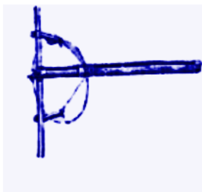
Figura 5 – Elipsógrafo de fio elástico: o fio (disposto horizontalmente) puxa o cursor móvel situado na haste horizontal.
