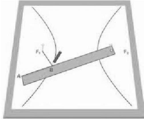
Além do fio, de comprimento  $f$ , utilizaremos uma base rígida de comprimento  $h = f + 2a$ , articulada por uma das extremidades  $s$  de um dos pinos a fim de que ela gire em torno dele. As pontas do fio são fixas a outro pino e à extremidade livre da haste  $A$ .
