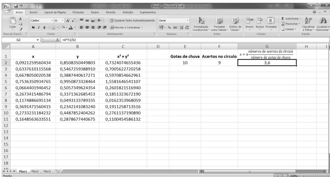
Figura 20 - Planilha do Excel calculando uma aproximação para  $\pi$  através do Método de Monte-Carlo.
