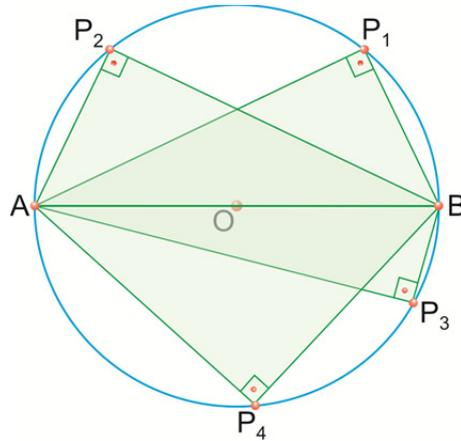
Figura 136: Arco capaz de  $90^\circ$ .
