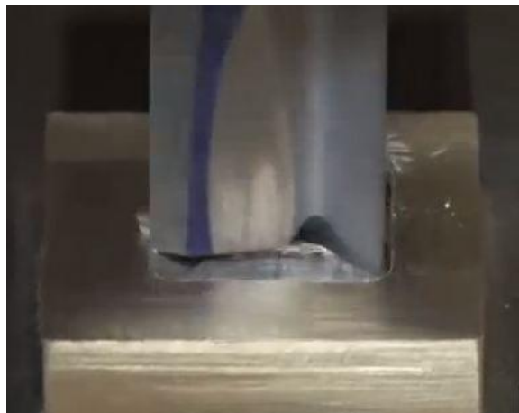
Figura 31 – Execução de furo aproximadamente quadrado Disponível em: https://www.youtube.com/watch?v=Jwk1FOj2xtE Acesso em: abril de 2014
