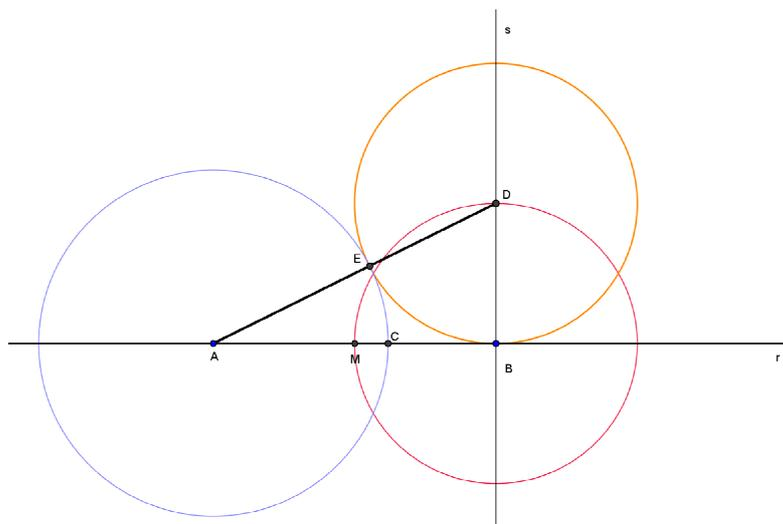
Figura 9 – Construção geométrica da divisão de um segmento  $\overline{AB}$  pelo ponto  $C$  em razão média e extrema.<sup>13</sup>
