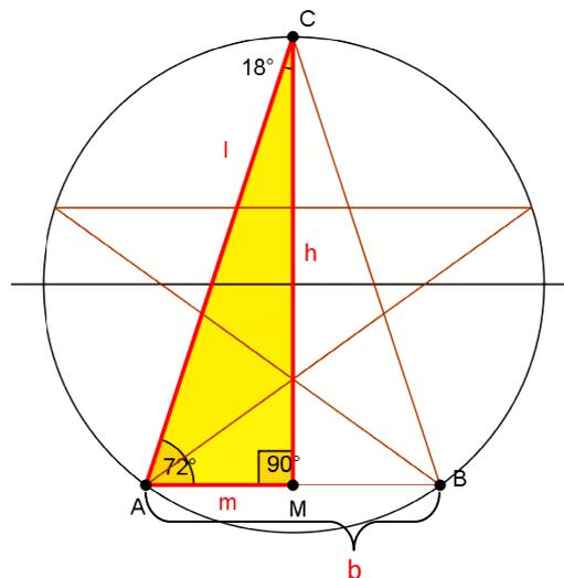
Figura 15 – Razões trigonométricas dos arcos de 18° e 72°<sup>19</sup>
