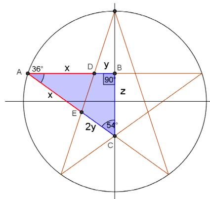
Figura 16 – Razões trigonométricas para os arcos de 36° e 54°<sup>20</sup>
