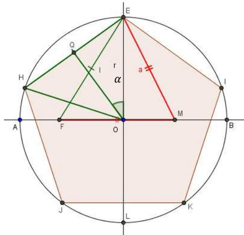
Seja  $Q$  o ponto médio de  $\overline{EH}$ ,  $\overline{OQ}$  é a altura do triângulo  $\triangle EOH$  e também bissetriz do ângulo  $\angle EOQ$  que chamaremos de  $\alpha$ . Note que  $\triangle EOQ$  é retângulo em  $Q$ , assim utilizando as razões trigonométricas no triângulo retângulo, temos:
