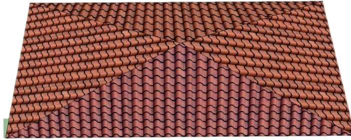
Figura 5.5: telhado de quatro águas
