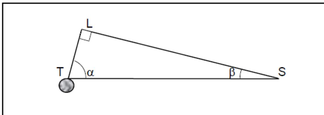
Figura 1.3: Triângulo retângulo construído por Aristarco para calcular a medida da distância da terra ao sol - Fonte: Bartoli[30], 2012, p.33
