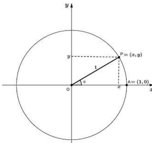
Figura 3.13: Definição do seno e cosseno no círculo trigonométrico - Fonte: Dados do autor.
