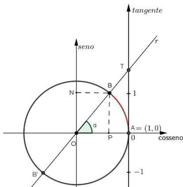
Figura 3.18: Círculo trigonométrico - Fonte: Dados do autor.
