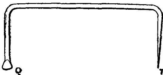
Figura 1.4: Planímetro de Prytz.
