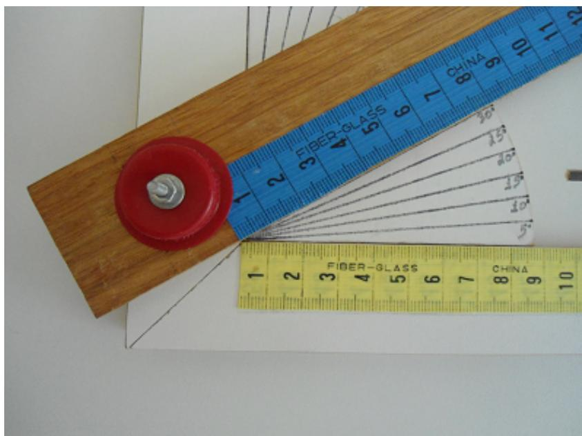
Figura 4.9: Fixação inferior com um parafuso da régua de movimentação angular.
