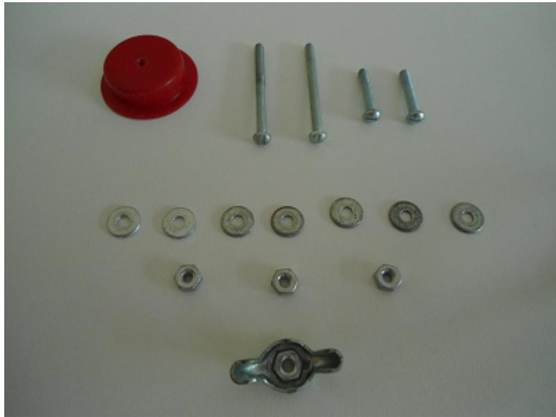
Figura 4.2: Uma base de plástico de apoio; Dois parafusos médios com  $16,0\text{mm}$  de comprimento; Dois parafusos pequenos com  $10,0\text{mm}$  de comprimento; Arruelas de apoio aos parafusos; Porcas com e sem borboletas para fixação.
