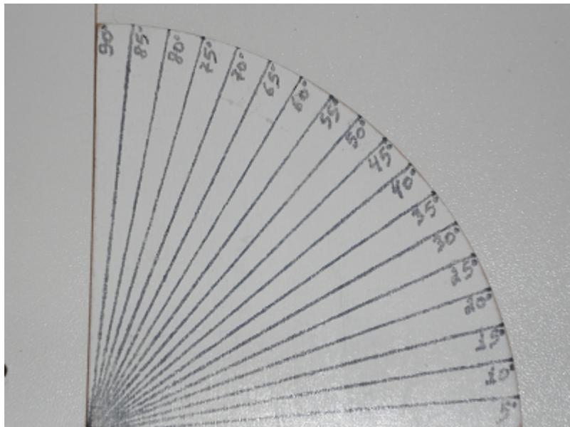
Figura 4.3: Medidas angulares marcadas em um quarto de uma circunferência feita em *MDF*( $5,0\text{mm}$ ).
