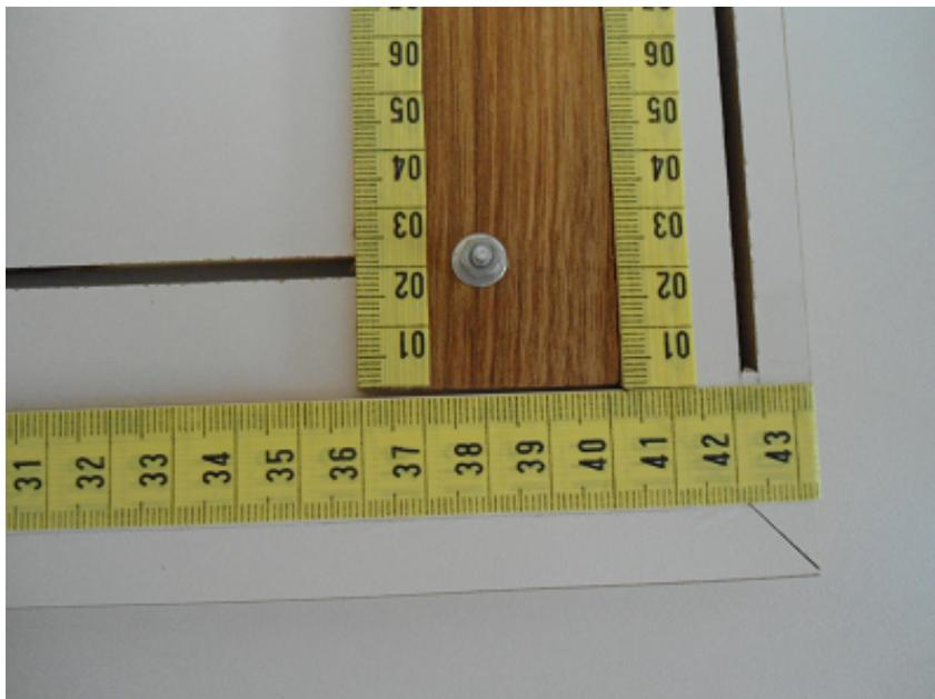
Figura 4.7: Fixação inferior com um parafuso da régua de movimentação horizontal.
