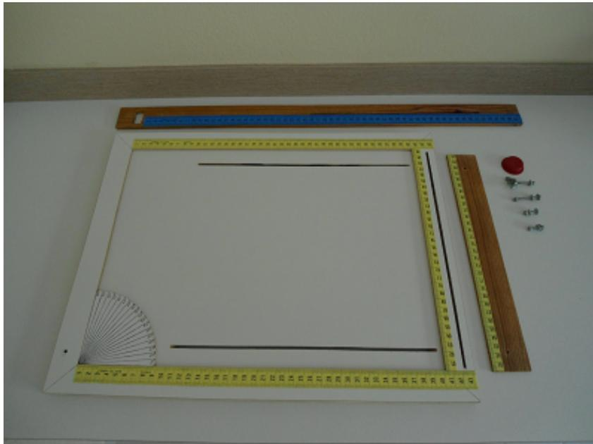
Figura 4.6: Material pronto para montar: Tábua centimetrada, duas régua de movimentação centimetradas, parafusos com porcas e arruelas e uma base de apoio plástica.
