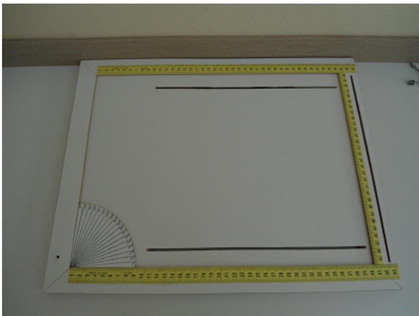
Figura 4.4: Fixação das medidas angulares e das fitas métricas nas extremidades da Tábua Trigonométrica.
