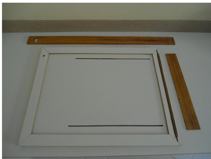
Figura 4.1: União das extremidades dos quatro pedaços de  $MDF(15,0mm)$  com o pedaço de folha de  $MDF(5,0mm)$ ; réguas de movimentação com medidas definidas e cortes longitudinais.
