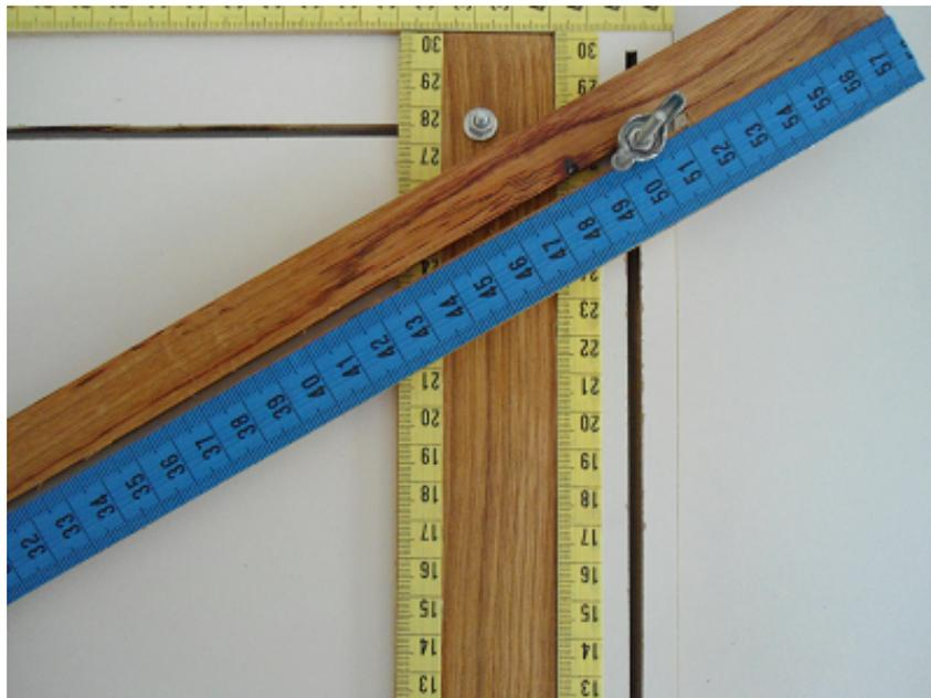
Figura 4.8: Fixação superior com um parafuso da régua de movimentação horizontal, e da régua de movimentação angular.
