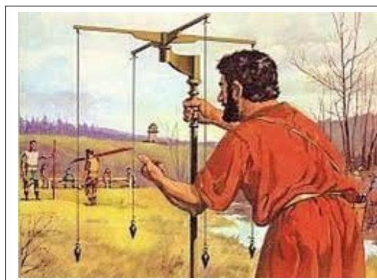
Figura 3.8: Detalhe de orientação do Groma
