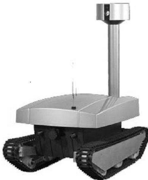
Figura 3.8: Robô de vigilância da RoboWatch
