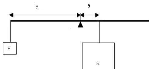
Figura 6 – Método da alavanca. Adaptada de (ASSIS, 2008)
