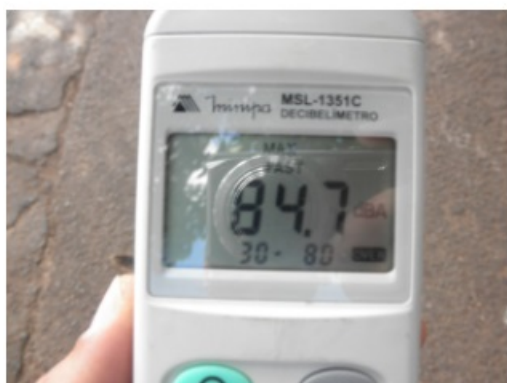
Decibelímetro, aparelho que mede os decibéis do som marca 84.7 (Foto: divulgação/SSP)
