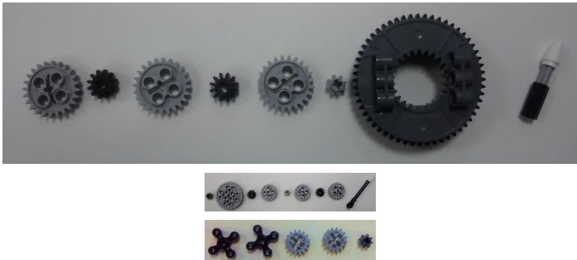
Figura – 26: Engrenagens envolvidas no processo de funcionamento das horas.
