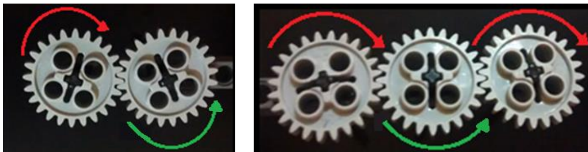
Figura – 13: Orientação dos giros entre as engrenagens motora e movida – Trem Simples.
