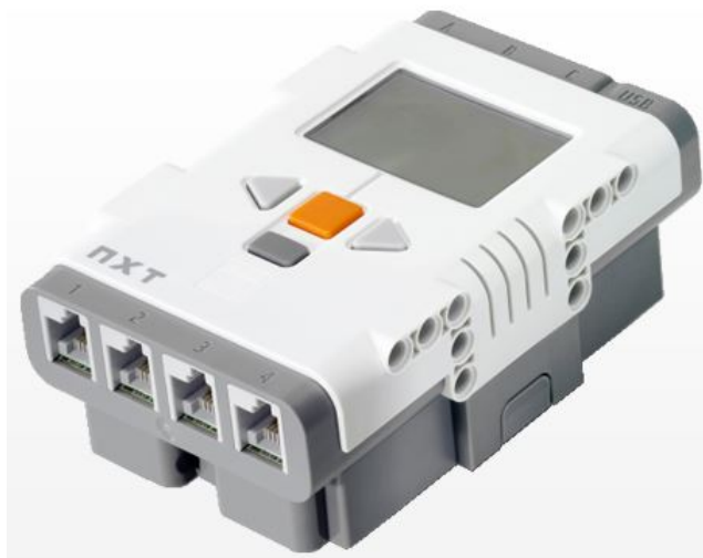
Figura 5: Brick NXT - O cérebro do robô
