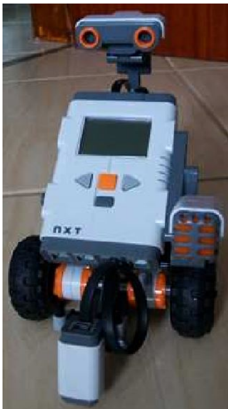
Figura 12: Mindstorm NXT 9797 - Modelo com sensor de ultrassônico de luz e som
