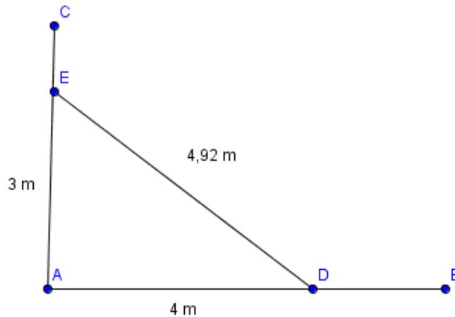
Figura 2.2: Passo II para garantir a perpendicularidade entre paredes
