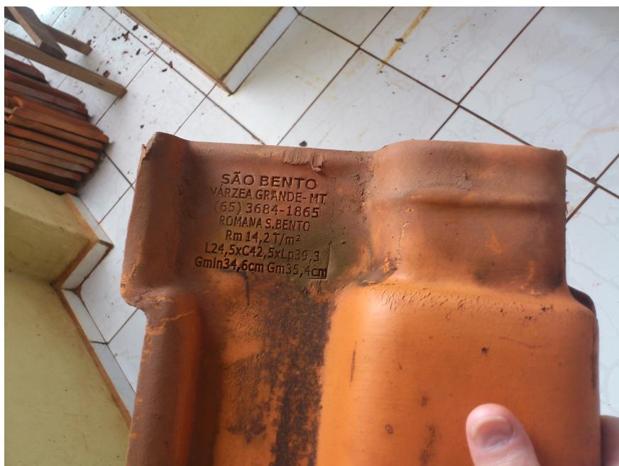
Figura 2.15: Modelo da telha que foi trocada
