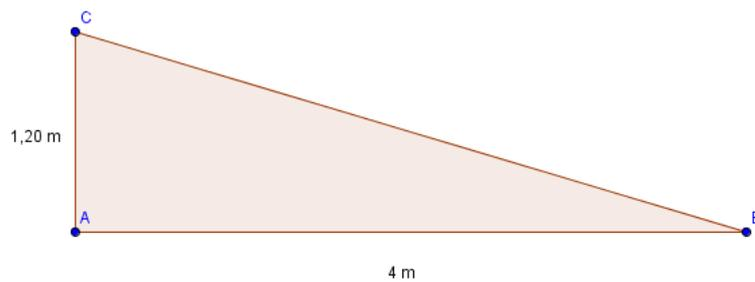
Figura 2.6: Construindo telhado meia-água II
