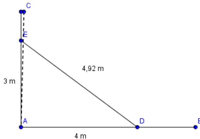
Figura 2.3: Passo III para garantir a perpendicularidade entre paredes
