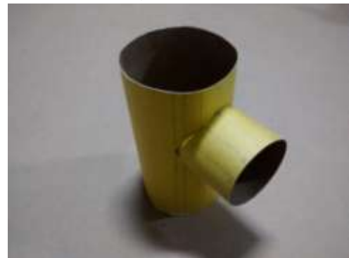
Intersecção 90° de diâmetros diferentes construída por aluno.
