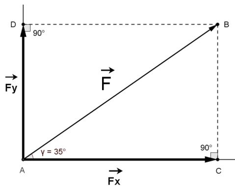
Figura 2.8: Força  $\vec{F}$  sendo decomposta e suas componentes  $(\vec{F}_x)$  e  $(\vec{F}_y)$ .
