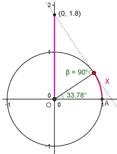
Figura 4.4: Ciclo trigonométrico e cossecante do arco  $x$ , indicada pelo segmento  $OF$ .
