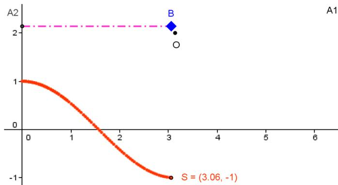
Figura 2.29: Bloco  $P$  preso por mola ao ponto  $A_2$  e descrição do movimento através da função cosseno.
