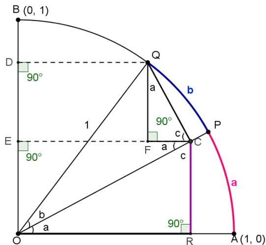
Figura 5.2: Arcos  $a$  e  $b$  no ciclo trigonométrico e cálculo de  $\text{sen}(a + b)$ .
