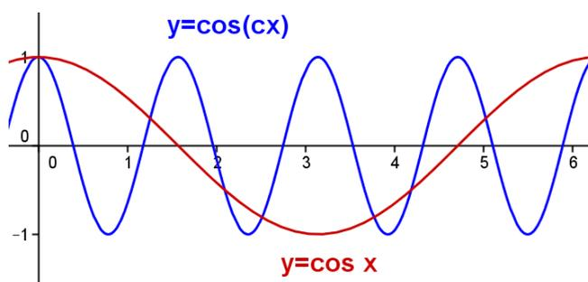
Figura 3.13: Função cosseno sofre alteração pelo parâmetro  $c$ .
