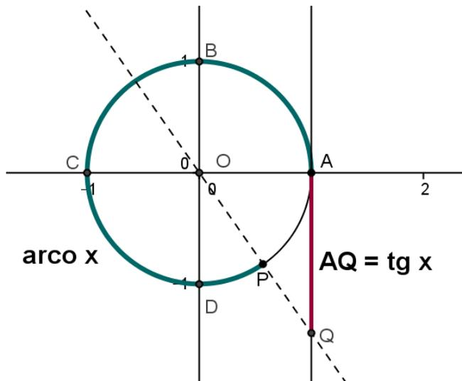
Figura 2.35: Ciclo trigonométrico com a marcação da tangente do arco  $x$  no quarto quadrante.
