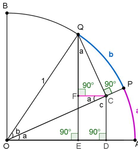
Figura 5.4: Arcos  $a$  e  $b$  no ciclo trigonométrico e cálculo de  $\cos(a + b)$ .
