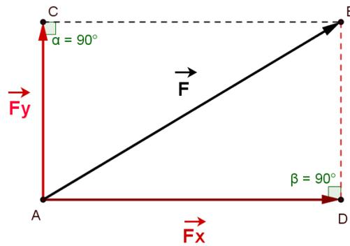
Figura 2.7: Decomposição da força  $\vec{F}$  e suas componentes  $(\vec{F}_x)$  e  $(\vec{F}_y)$ .
