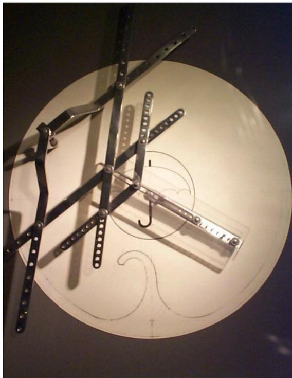
**Figura 42:** Pantógrafo usado para criar anamorfismos cônicos. (KENT, 2013)
