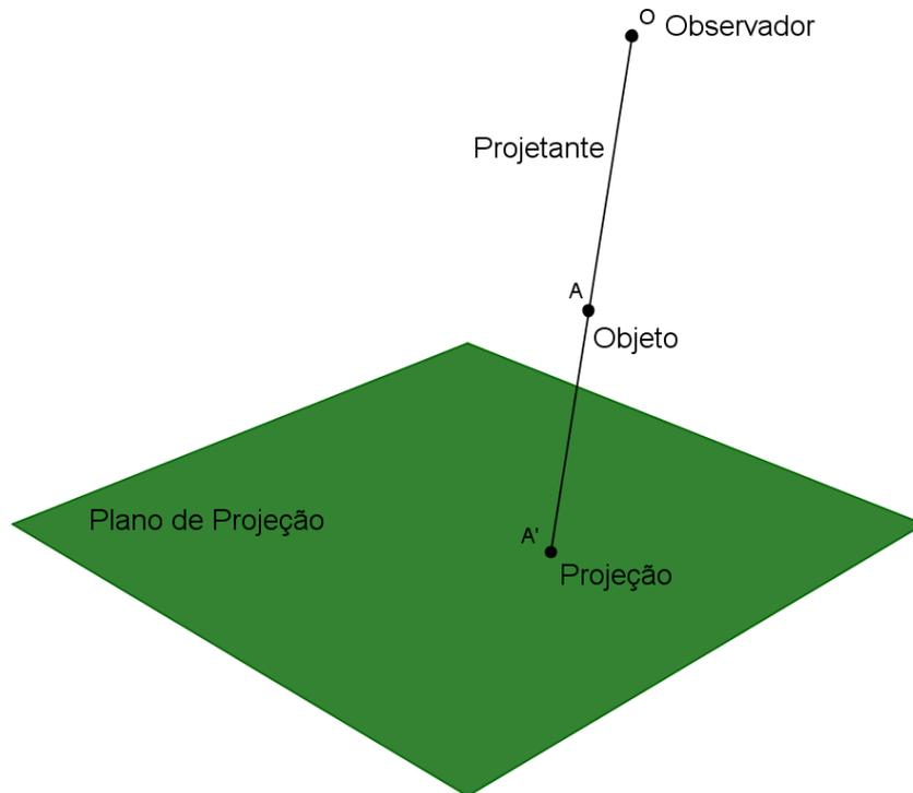
**Figura 15: Elementos no Sistema de Projeção.**
