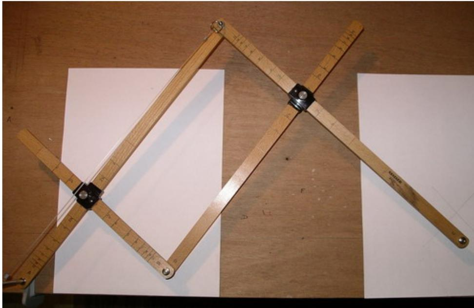
**Figura 43:** Pantógrafo tradicional, usado para transladar, ampliar ou reduzir imagens. (CASA DAS CIÊNCIAS, 2011)
