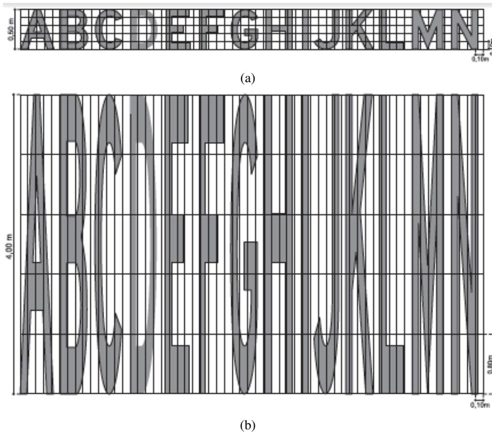
**Figura 20: Modelo para letras de legendas de sinalizações de trânsito horizontais: (a) sem deformação e (b) com deformação para ser pintado em vias rurais. (CONSELHO NACIONAL DE TRÂNSITO, 2007)**
