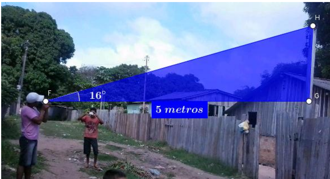
Figura 36: Exemplo de medição de altura usando teodolito
