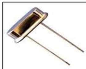
Figura 36 - Cristal oscilador de 16M Hz.
