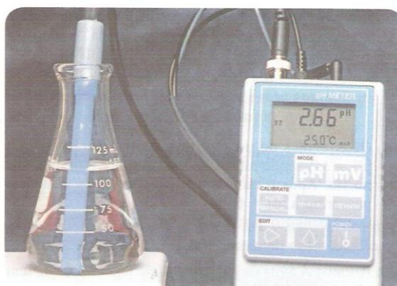
▲ Um medidor eletrônico de pH (peagâmetro digital) em uso para medir o pH de uma solução aquosa de ácido metanoico ( $\text{HCOOH}$ ).
