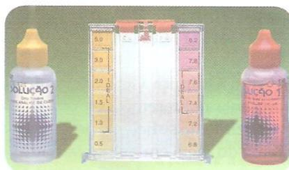
▲ *Kit* para a medida de pH de piscinas, usando o líquido vermelho e a escala à direita. O *kit* também permite medir a concentração de cloro na água, em partes por milhão (ppm), utilizando a solução e a escala à esquerda.
