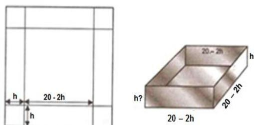
Figura 14: Construção de uma caixa.
