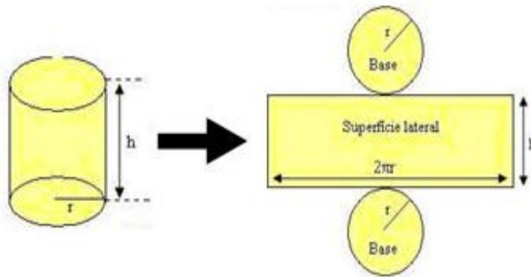
Figura 5: Planificação do cilindro.
