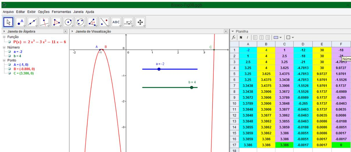
Figura 12: Cálculo da raiz de  $2x^3 - 3x^2 - 11x - 6 = 0$  no GeoGebra, utilizando  $a = -2$  e  $b = 4$ .
