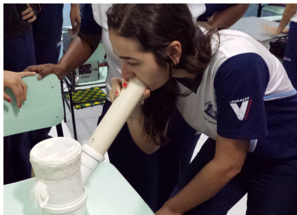
Figura 4.10: Produção de figuras geométricas na placa de Chladni através da voz. (Fonte: o autor)
