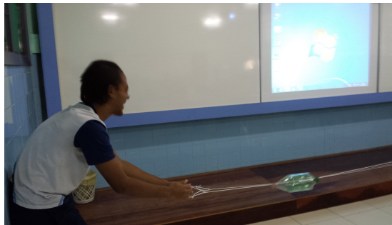
Figura 4.8: Produção do efeito Doppler através do brinquedo vai-e-vem confeccionado com barbante e garrafas PET.
