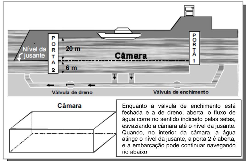
A câmara dessa eclusa tem comprimento aproximado de 200 m e largura igual a 17 m. A vazão aproximada da água durante o esvaziamento da câmara é de  $4200 \text{ m}^3$  por minuto. Assim, para descer do nível mais alto até o nível da jusante, uma embarcação leva cerca de:
