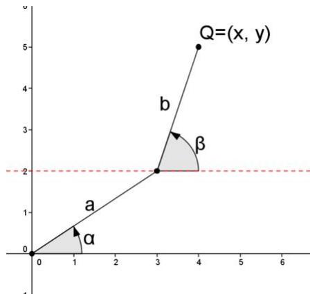
Figura 10 – Modelo matemático do braço robótico
