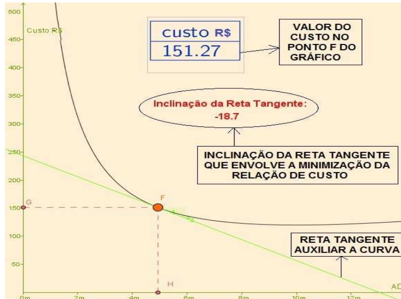
Figura 32: Gráfico de Custo da rede versus Comprimento \overline{AD} do terreno
