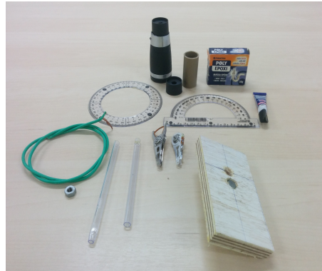
Figura 3.1: Materiais necessários para Construção do teodolito
